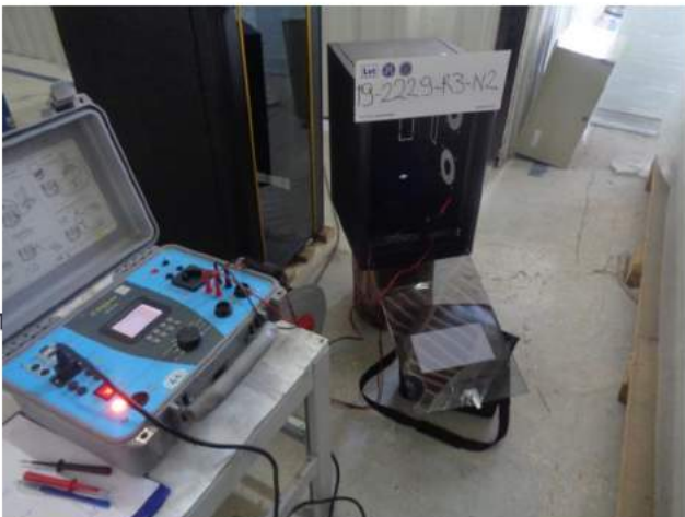
Toprağa Bağlantı Deneyi (Md. 9.6)
