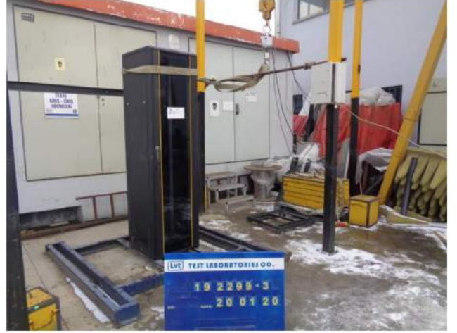
Bükülmezlik Deneyi (Md. 9.4)
