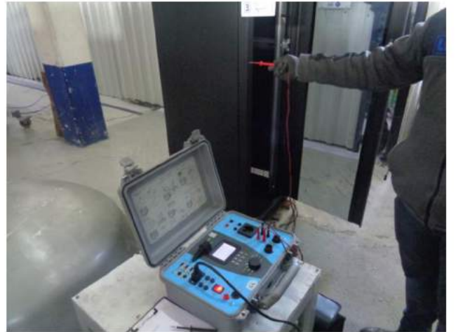
Toprağa Bağlantı Deneyi (Md. 9.6)
