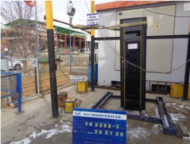
Bükülmezlik Deneyi (Md. 9.4)
