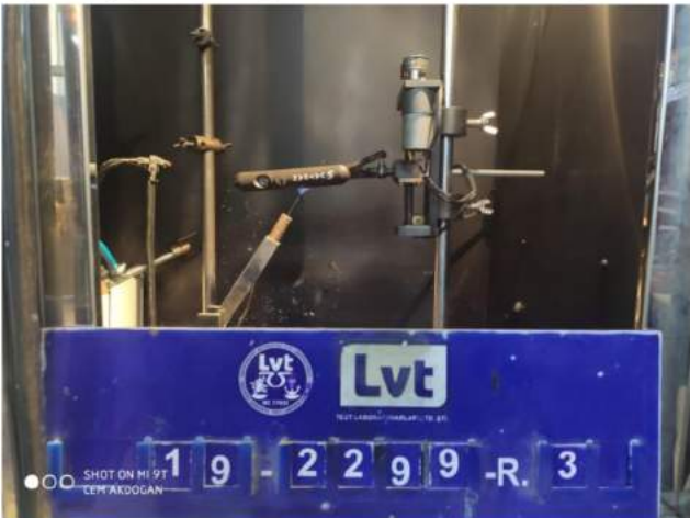
Alevlenebilirlik Deneyi (Md. 9.9)
