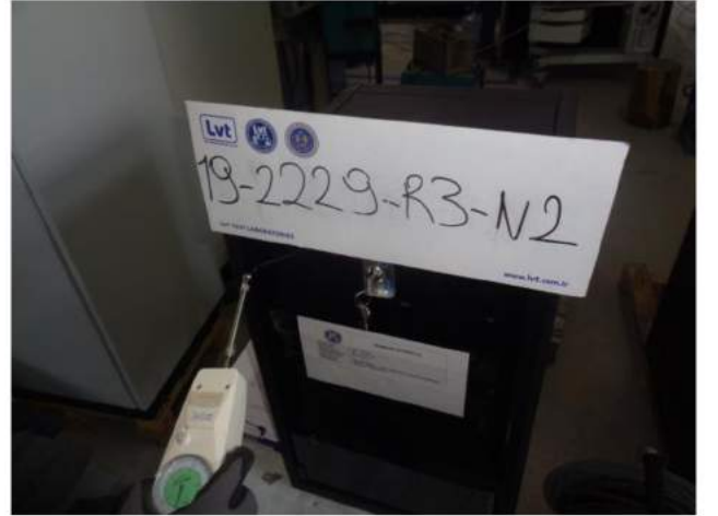
Mahfazalar Tarafından Sağlanan Koruma Dereceleri (Md. 9.7) (Numune 2)
