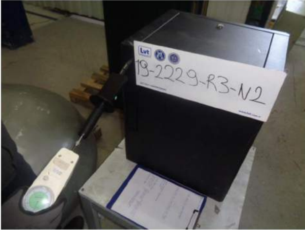
Mahfazalar Tarafından Sağlanan Koruma Dereceleri (Md. 9.7) (Numune 2)
