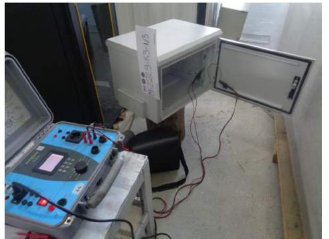
Toprağa Bağlantı Deneyi (Md. 9.6)
