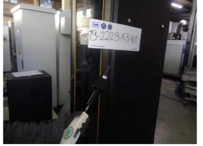
Mahfazalar Tarafından Sağlanan Koruma Dereceleri (Md. 9.7) (Numune 1)
