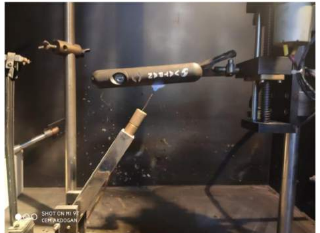
Alevlenebilirlik Deneyi (Md. 9.9)
